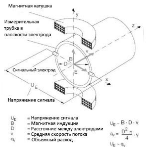
Схема электромагнитного расходомера
