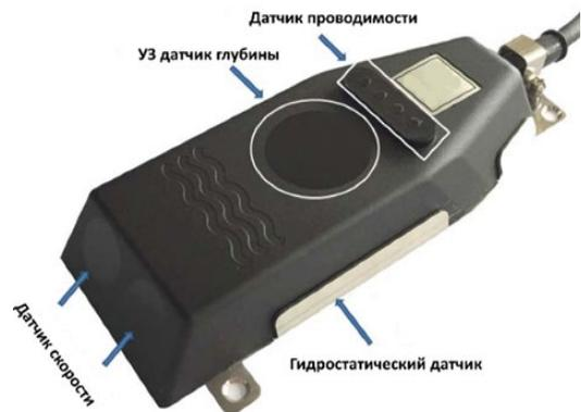
*Рисунок 1.2. Комбинированный погружной датчик скорости и уровня*
